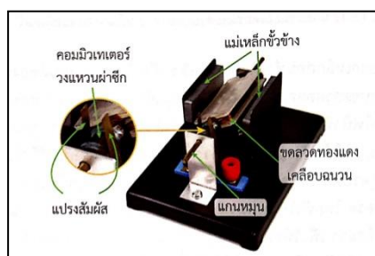
รูป 15.43 ส่วนประกอบของมอเตอร์ไฟฟ้ากระแสตรง
