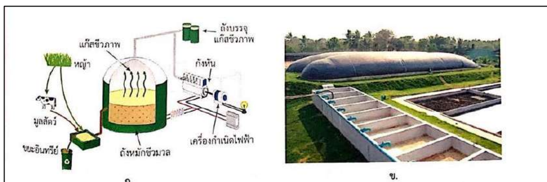
รูป ก. ขั้นตอนนำชีวมวลมาหมักจนได้แก๊สชีวภาพสำหรับนำไปผลิตไฟฟ้า ข. บ่อหมักแก๊สชีวภาพ
