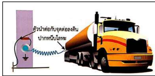
รูป 13.52 การต่อตัวนำระหว่างถังเก็บน้ำมันของรถขนส่งน้ำมันกับจุดต่อลงดิน
