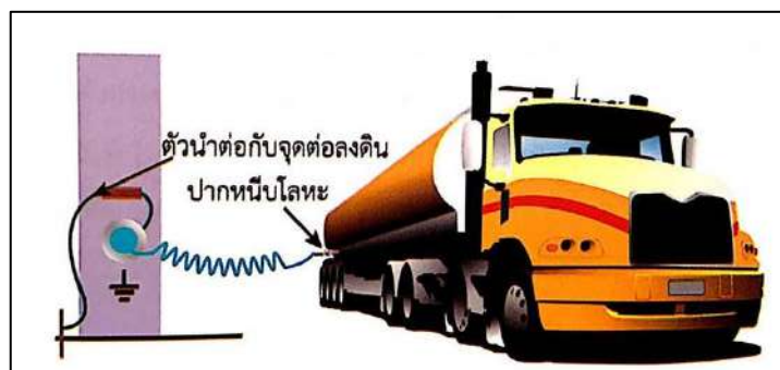
รูปการต่อตัวนำระหว่างถังเก็บน้ำมันของรถขนส่งน้ำมันกับจุดต่อลงดิน
