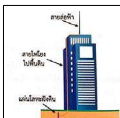
รูป 13.49 สายล่อฟ้าบนตึกสูงช่วยให้ประจุจากฟ้าผ่าเคลื่อนที่ลงไปยังพื้นดิน
