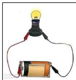
รูป 14.1 การต่อหลอดไฟเข้ากับแบตเตอรี่ให้ครบวงจร
