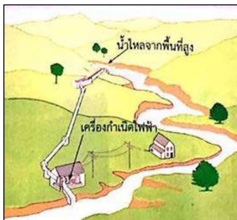
รูปโรงไฟฟ้าพลังงานน้ำขนาดเล็ก
